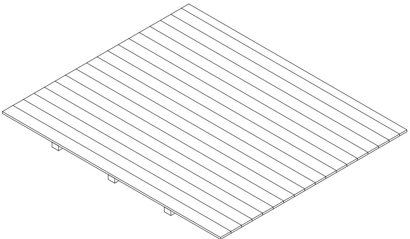
**Wir empfehlen als Fundament für Ihr Gartenhaus eine vollflächig festgegründete, gepflasterte oder betonierte Fläche. Wahlweise ist auch ein Punkt- oder Streifenfundament möglich.**
